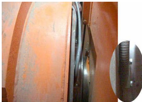
شکل (۴-۴): سنسورهای شتاب بر روی پوسته یاتاقان
