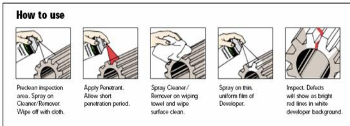
شکل (۲-۱۹) مراحل اجرای تست مایعات نافذ
